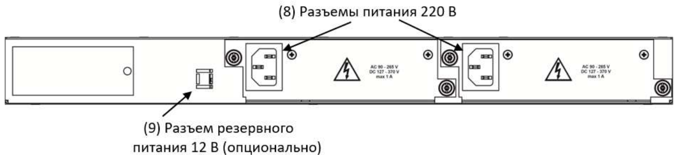
Рисунок 4.2.7 – Расположение разъемов на задней панели коммутатора Корунд-4С-16М8Е
